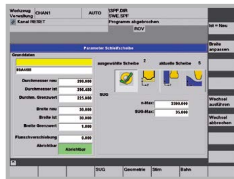
最多可用于100片砂轮和30个修整工具的管理功能
