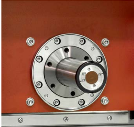
自动砂轮动平衡，安装于主轴内
