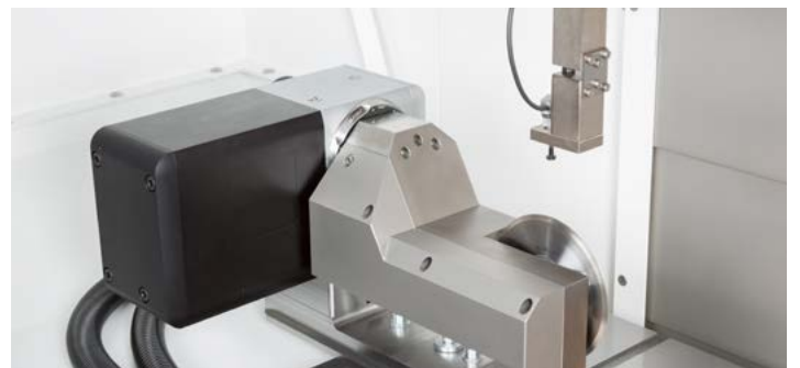
摆动式PA-T130修整器：通过机床运动轴和修整器的数控摆动轴进行连续轨迹的轮廓修整。电子测量装置配置支架、探针和校准球。
