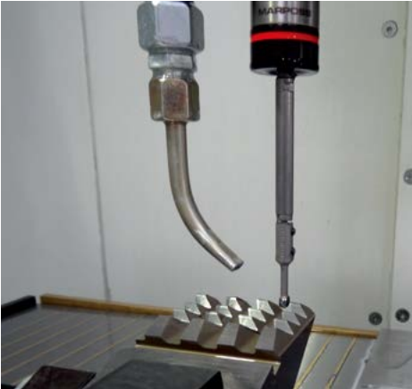
测量探针，从测量位置气动收缩，测量精度为 \pm 1 \mu\text{m}
