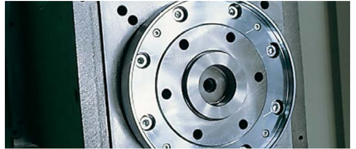
短锥套筒式主轴连接，砂轮重复定位精度高
