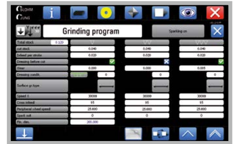
3层自动化磨削循环：结合集成修整循环的粗磨、半精磨、精磨、光磨。完成整个循环仅需几个参数
