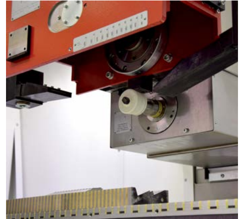
增加卧式磨削主轴，18000rpm;13kW
