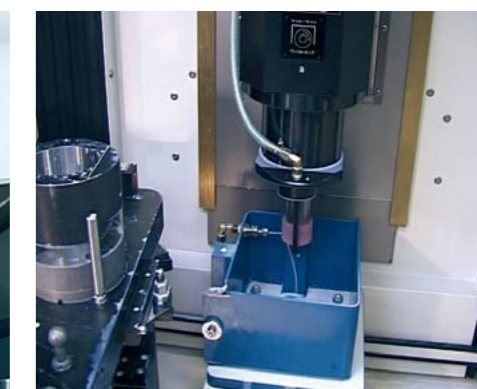
采用单点金刚笔的 CNC 修整
