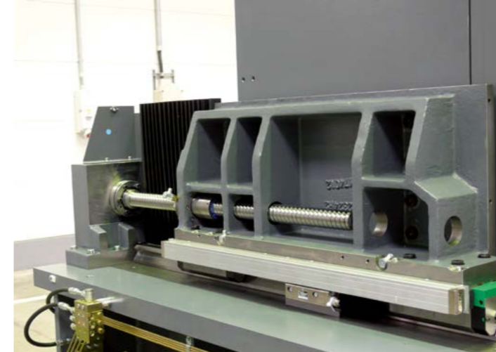
Z轴：配置直线导轨、再循环滚珠丝杆和线性光栅尺
