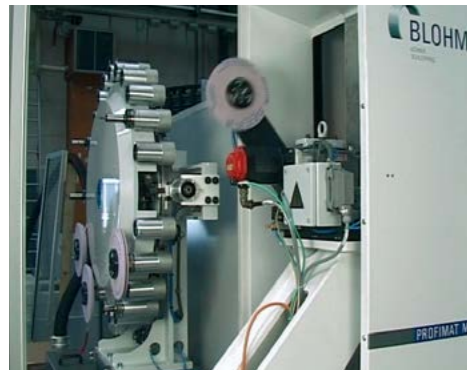
砂轮更换系统：最多可管理24个工具 12 x D=300 或 8 x D=400
