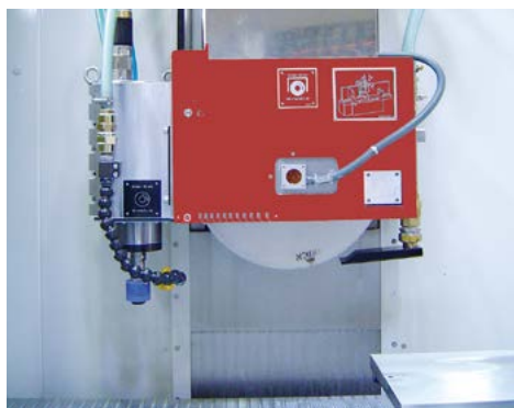
立式辅助磨削主轴：适合工模具车间使用，功率高达6kw，最高转速90,000rpm
