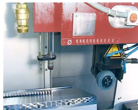
测量探针，测头，气动控制从测量位置返回。最多可扩展至两个半轴控制，测量精度 \pm 1\mu\text{m}
