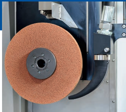
数字控制冷却液供应和一体化高压砂轮清洗
