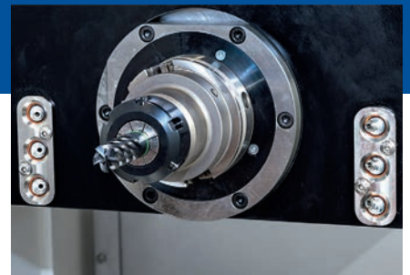
磨削支架上用于铣刀和钻具的冷却液喷嘴
