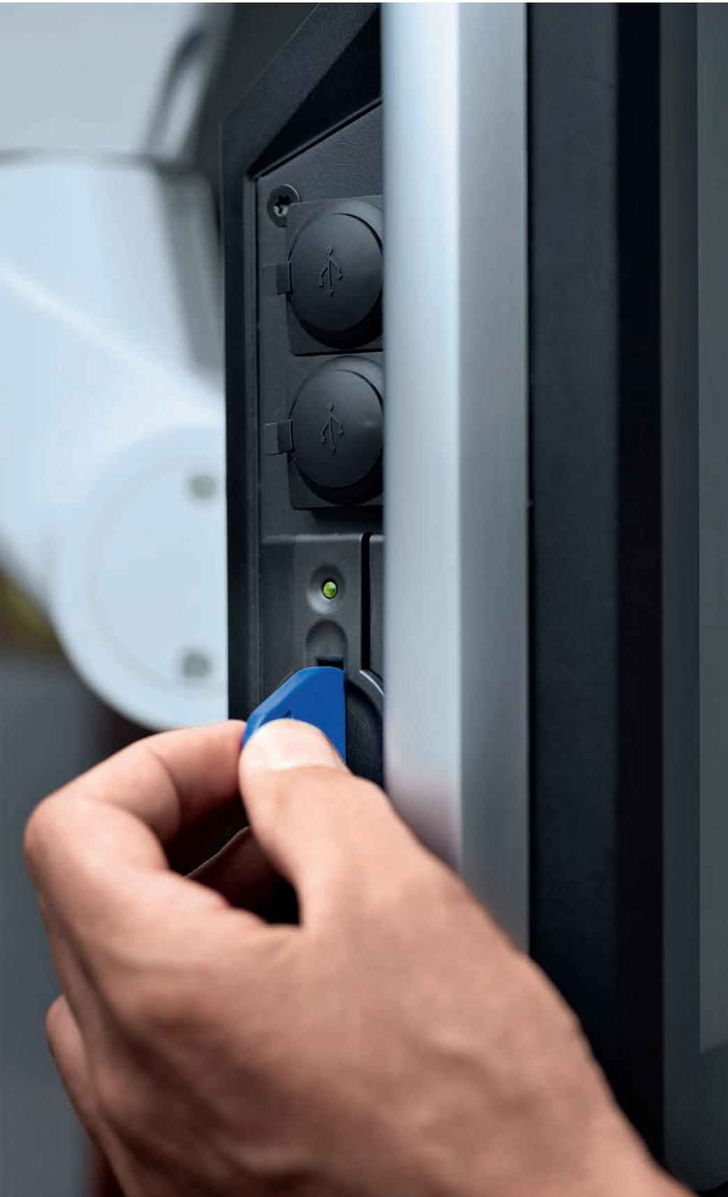
最新的要求也是在安全方面：一个现代化的 RFID 芯片读取器取代了此前的钥匙开关。
