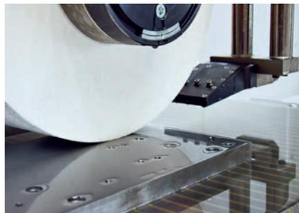
此外, 该机床还配备了一个可承受 1500 千克载荷的电永磁吸盘 (DQ18, 可选配 DQ13), 以及一个带单颗金刚石的金钢石夹持器, 并为使用可选的手动平衡单元做好了准备。该机床不需要 PLANOMAT 系列机床
