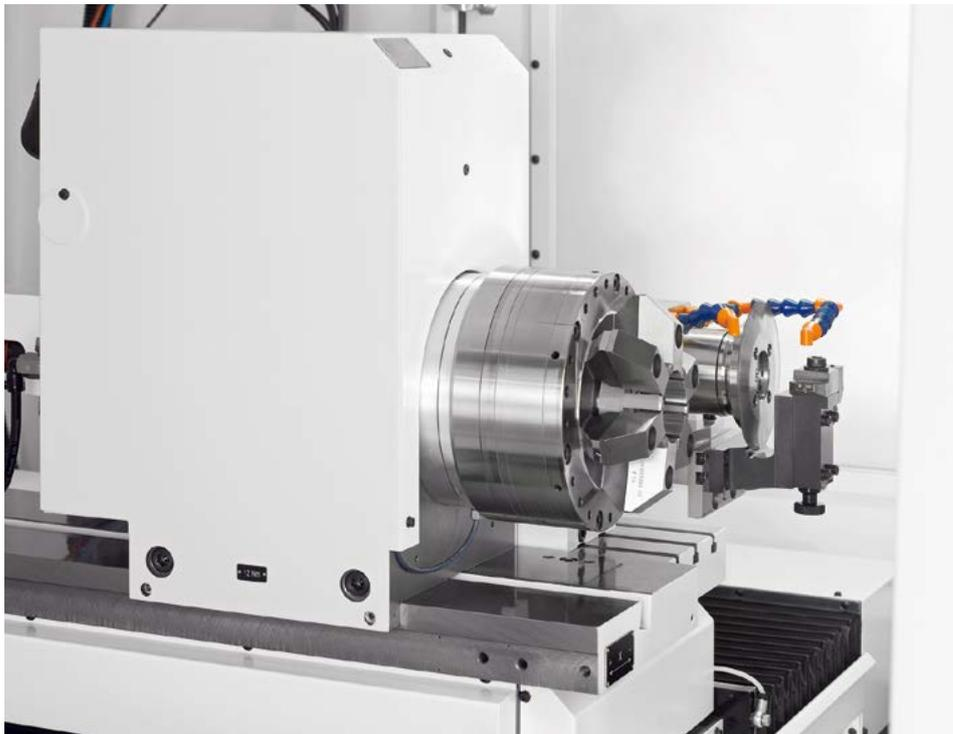
高精度工件头架配备了专用轴承，保证了高圆度精度。主轴连接端头符合 DIN/ISO 702-1 标准。
