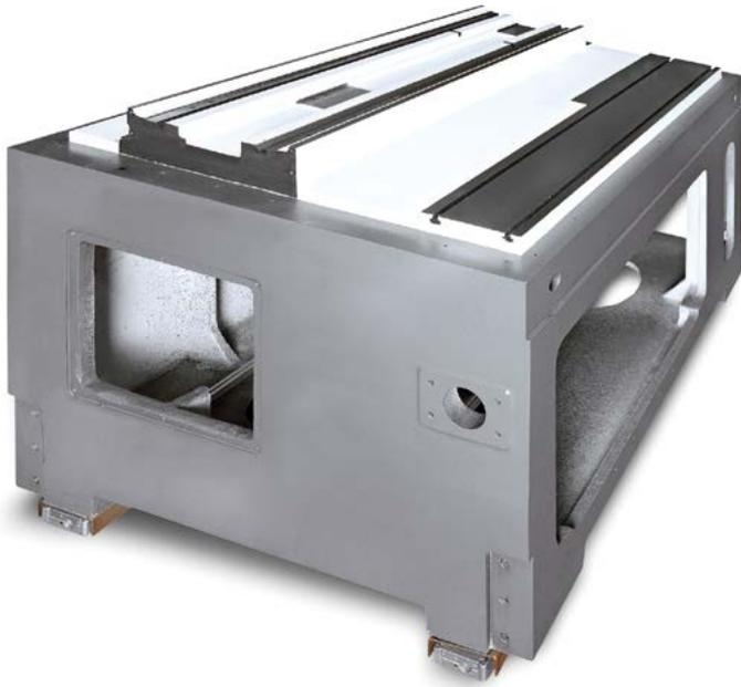
机床床身由铸铁制成，它是高精度十字滑板和磨削轴安装单元的基座。X轴导轨的支承直接压铸在机床床身上。在机床床身上部的其余部位使得冷却液环绕床身回流经过一个冷却液水箱至冷却液装置或冷却液清洁装置。
