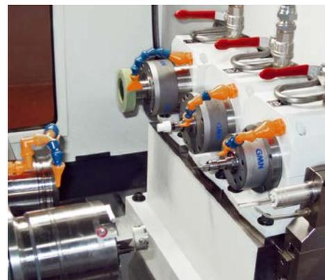
模块化的磨削主轴支架设计能够最佳的完成各种磨削任务。根据要求，无论是单个磨削主轴还是多个主轴都由永久固定的，刚性很好的主轴支架支承。基本配置可选择一个、两个或三个主轴平行布置。最多可布置三个磨削主轴，这取决于工件的具体几何形状。在配置两个或三个主轴的情况
