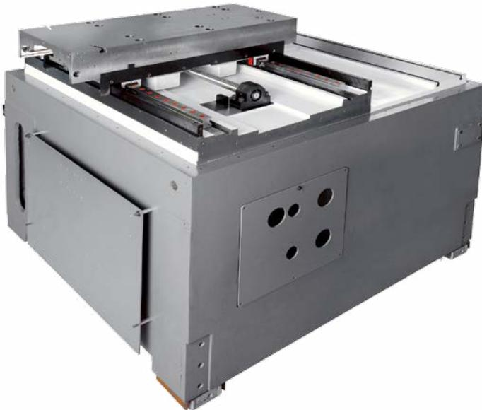
规格尺寸较大的十字滑板由优质铸铁制成。纵向和横向滑台采用带有预紧力的高精度线性导轨（滚柱）。X轴和Z轴通过带有预紧力的精密无背隙双螺母滚柱丝杠系统驱动。导轨和循环滚珠丝杠配有内置式中央润滑系统。X轴被伸缩管有效覆盖。Z轴两端配有组合伸缩管。由清洁的正压空气和护板对光栅尺进行保护。具有直驱功能的驱动电机(交流伺服电机)也被护板完全覆盖。
