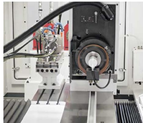
外锥面和内锥面可有两种加工方式。一种是利用手调范围可达 $21^\circ$  (对于S110, 则为 $31^\circ$ ) 的回转式工作台来加工, 另一种是利用固定式工作台和经过适当修整的锥形砂轮来加工。
