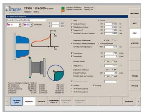
有两种操作系统可供选择：StuderSIM 和 StuderWIN。两者都适用于内圆磨削的应用并且能够对磨削、修整及工艺辅助式测量等所有基础操作进行编程。这些基本程序，例如端面磨削、内径磨削、锥面磨削、螺纹磨削、砂轮修整及测量，都可以在参数输入窗口中加以定义。这种编程形式高度灵活，方便用户使用，并注重实际生产应用。每种程序编制均配备有动态帮助系统，能够在整个磨
