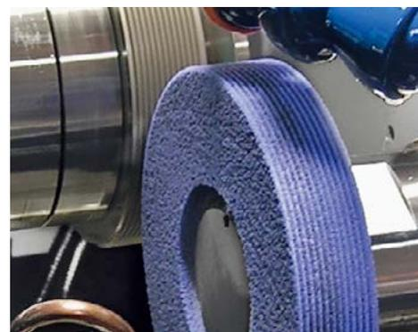
因为具有多种修整方式，机床能够以最佳方式满足各种应用和工件加工要求。除固定式修整单元外，还可安装供回转式修整工具使用的装置。后者尤其适用于修整以陶瓷作为粘结剂的CBN砂轮。借
