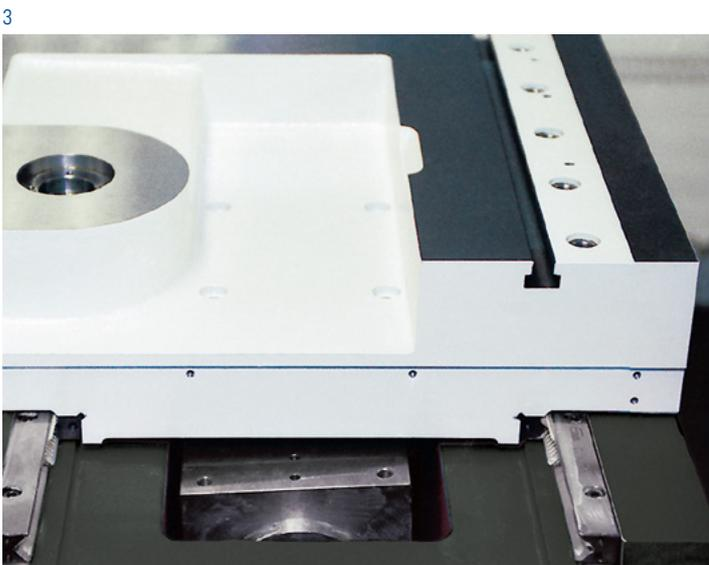
滑板在整个行程范围内均完全帖服在床身导轨上面。它们得益于在380毫米（14.9"）内0.0015毫米（0.000,06"）的出色直线度！
