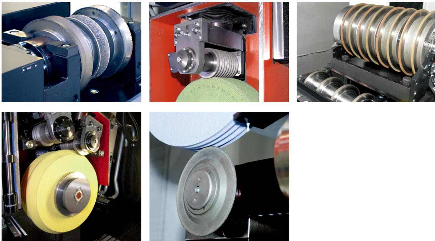
砂轮修整是决定整个磨削过程效率的关键因素之一。针对这一关键工艺步骤，MÄGERLE可提供顶置式和台式砂轮修整系统等不同的专业解决方案来满足不同类型的加工需求。顶置式砂轮修整装置可在磨削过程中实现连续式修整（CD）或者断续式修整（IPD）。台式砂轮修整装置可采用固定式砂轮修整工具或者旋转式砂轮修整工具，比如碟片式修整滚轮、钢挤轮和成型修整滚轮实现最理想的砂轮修整效果。MÄGERLE采用伺服电机来驱动砂轮修整装置，以此实现对砂轮修整装置转速的编程控制。
