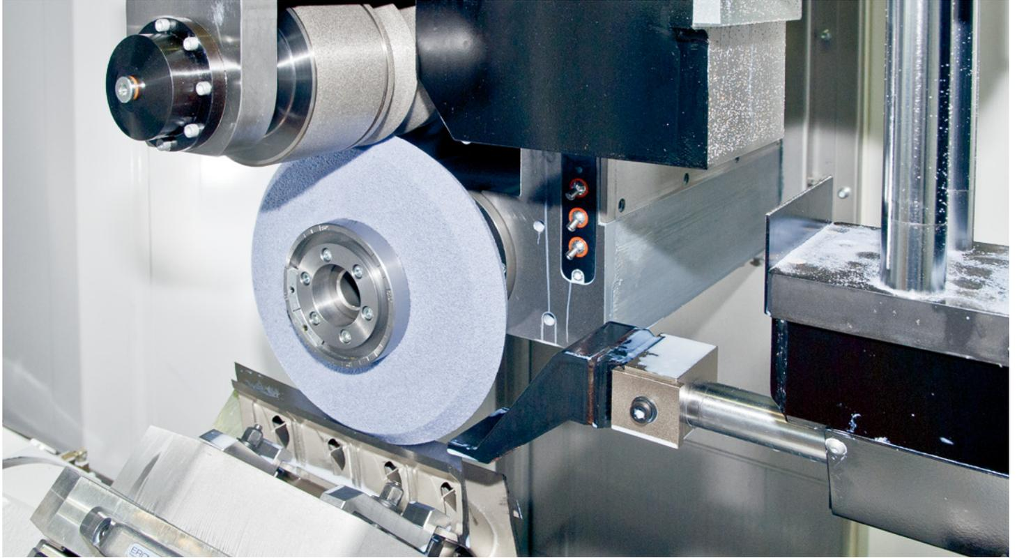
优化的加工冷却方法显著降低加工成本。磨削中心采用双数控轴控制的冷却喷嘴系统，系统能根据相关砂轮的几何尺寸和位置在加工过程中将冷却液准确有效地喷射至加工区域。可选配带轮廓的冷却喷嘴，使得冷却液精确地覆盖工件的加工区域轮廓。这样只需少量的冷却液就能获得最大的冷却效果。通入压缩空气的迷宫式密封结构为安装在加工区域内的轴承提供了良好的保护，有助于整个系统的长期可靠的运行。
