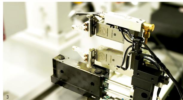
长度定位测量头适用于间断或非间断表面的被动长度定位。它有一个电动或气动探头并使用一个测量电路。
