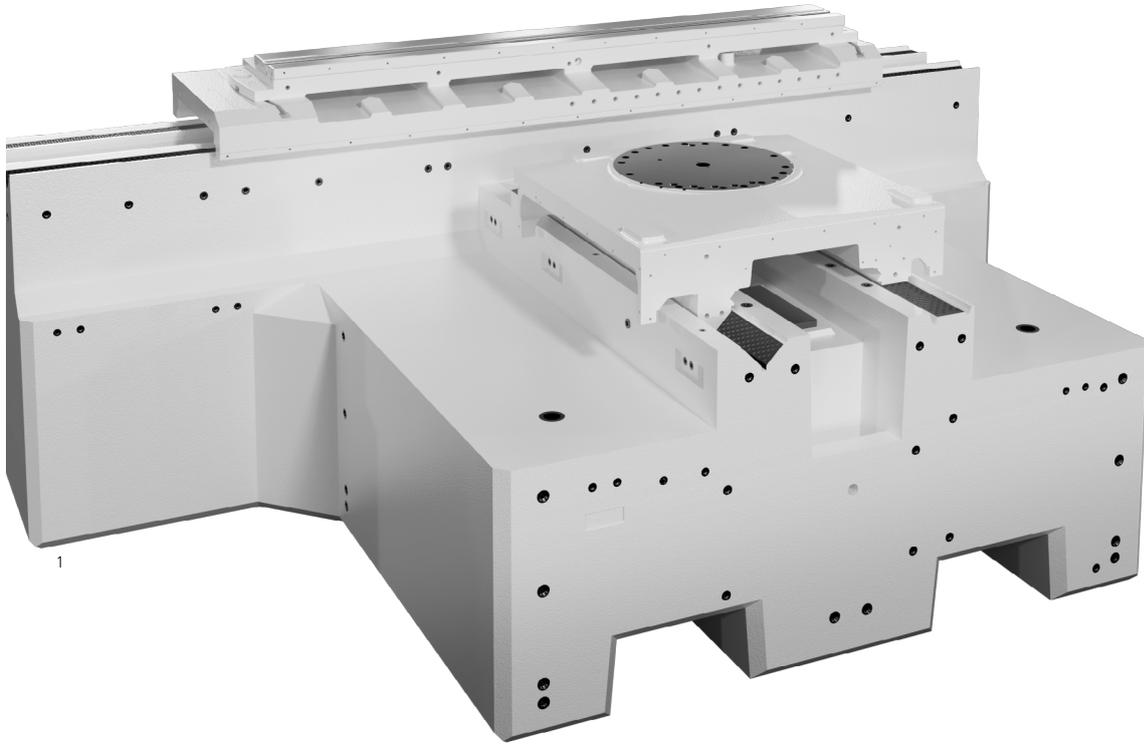
纵向和横向滑台由高品质的灰铸铁制造而成，具有高精度，经磨削加工且具备优化间距的V-平导轨，更适应机床的整体刚性要求。两滑台在运行速度范围内始终完全贴合在床身的导轨上，从而为确保在 650 mm 的磨削测量长度上达到 0.0025 mm 的优异直线度奠定了坚实的基础。滑台由直径为 40mm 的滚珠丝杠驱动，该滚珠丝杠通过抗扭性能优异的弹性联轴器与三相伺服电机连接。
